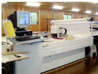
CAM(コンピュータ裁断作業)装置
